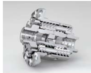
トルセンとは特殊なギヤ機構により、4つの車輪それぞれにエンジンの駆動力を最適に配分する装置です
