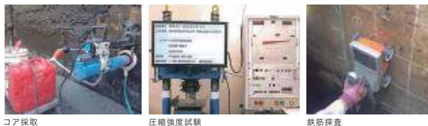
コア採取 圧縮強度試験 鉄筋探査
