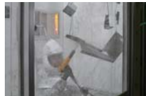
粉体塗装吹付作業
