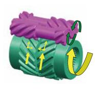
サイドギヤとプラネタリギヤ、プラネタリギヤとプラネタリギヤが常に噛合った状態で構成されている為、 差動を生じようとする際に、それぞれの噛合い反力 による抵抗を差動制限力として利用。ギヤ噛合い で発生した反力を利用し、各部位の摩擦摺動により 差動制限力を発生させる。
