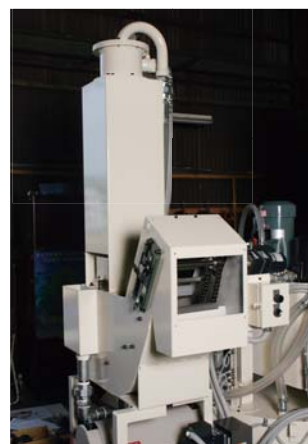
コンベア付砥粒沈澱槽 (拡大)
