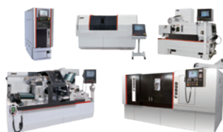
■ センタレス研削盤シリーズ ワークのサイズ・形状に合わせた多種多様なラインアップ。
