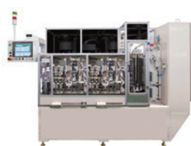
■ ピニオンギヤニードル組付機 軸受・パワーステアリング等の部品を自動組付け・自動測定。製造工程の少人化システムをご提供します。
