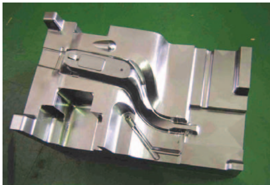
図7 スイッチレバー金型 Switch lever die mold
