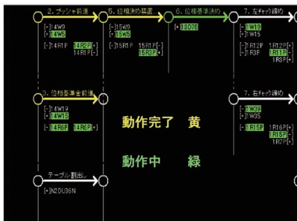
図 7 サイクル線図モニタ Monitor of Circuit Diagram
