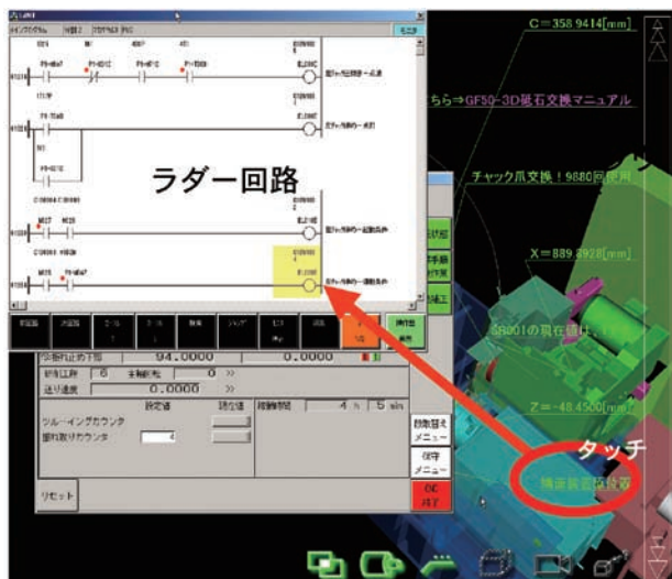
図 8 操作盤の状態表示例 Example of Operation Panel Status Display
