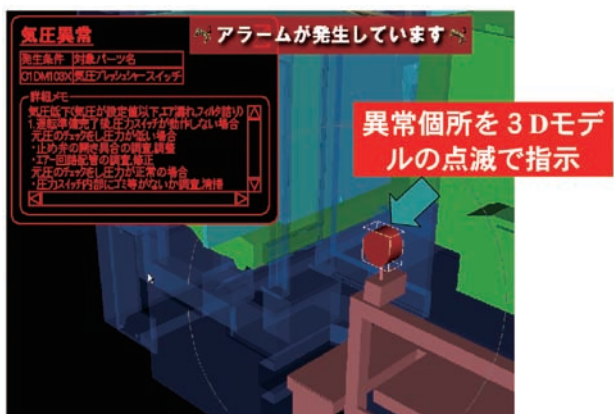
図 9 3D 異常個所特定表示の例 Example of 3D Fault Locating Display
