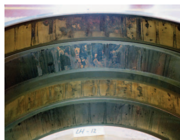
図4 ワークロールネック軸受損傷事例 Example of work roll neck bearing failure
