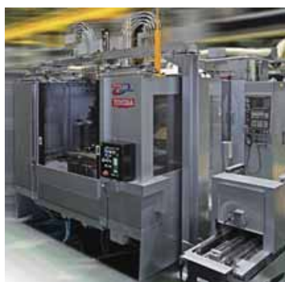
図4 上部カプラ方式による油圧供給 Upper coupler system of hydraulic supply
