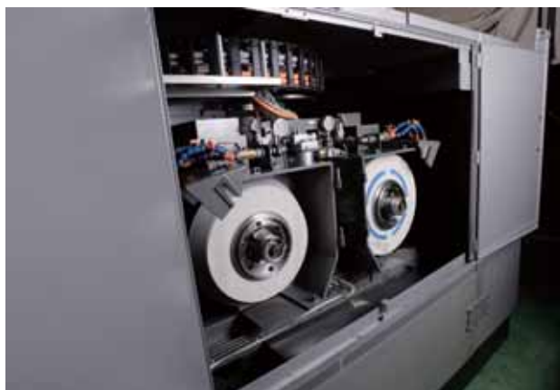
図8 砥石交換スペース Wheel changing space
