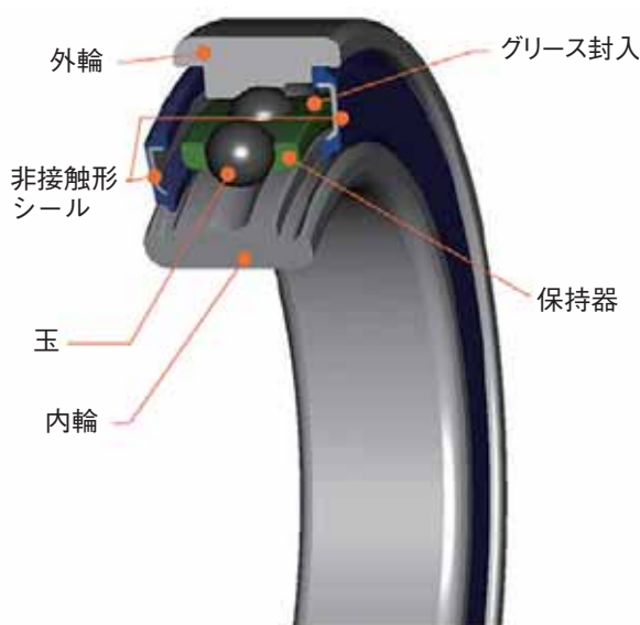
図 5 ハイアビリーシール付アングュラ玉軸受
