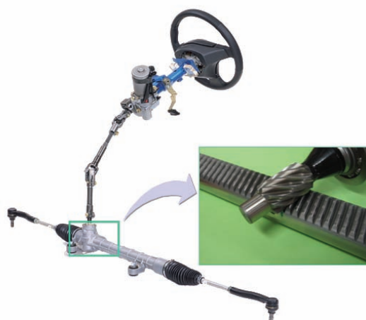
図1 ステアリング用ラック&ピニオン Rack and pinion steering gear
