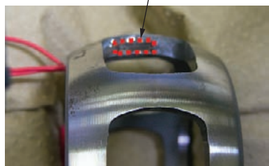
図10 保持器のひずみ測定 Retainer strain measurement
