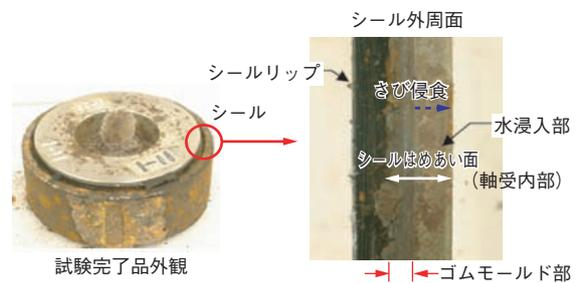
図4 試験完了後のシール外径はめあい部（一例）
