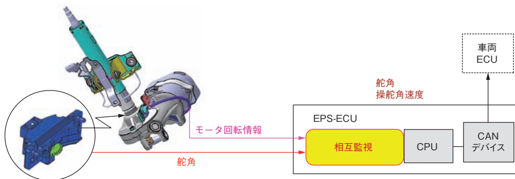
図4 舵角センサ信号とモータ回転情報との相互監視 Mutual monitoring of angle sensor and motor rotation information
