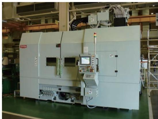
図1 VGX-100 超大型立形研削盤
