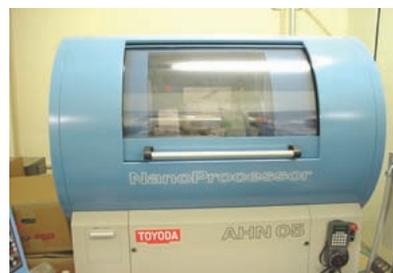
図7 ジェイテクトと共同開発した超安定・超精密非球面研削装置
