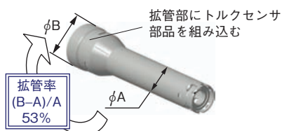
図5 センサハウジングのパイプ材プレス化 Pressed pipe for sensor housing
