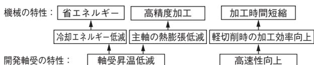
図2 開発軸受の特性と機械特性
