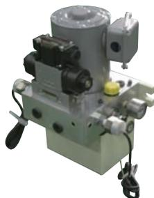
現在の工作機械における油圧の役割はクランプ圧力の保持が大半を占める。クランプ時の油圧は圧力保持のみで仕事はほとんどしないが、ポンプとモータを連続運転して行くと大きなエネルギーの損失となる。今回、クランプ時の圧力保持に用途を限定し、間欠運転による超省エネルギーとクランプ装置の直近に配置可能な超小型油圧ユニットを開発したので紹介する。
