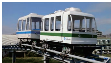
図3 低コスト・省エネルギー・高頻度・自動運転軌道システム「エコライド」
