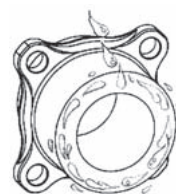
図5-a 外輪端面の水浸入イメージ Image of water influx onto the end face of the outer ring
