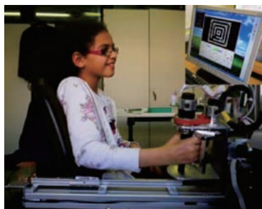
図2 片まひの子供のために EPFL ロボティクスシステム研究所で設計された 2 自由度の手のリハビリ装置
