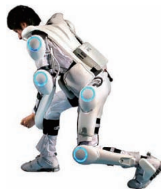
図4 サイバーダイン社 (日本) のヒトアシストロボットスーツ型装置 HAL "Robot Suit" human assist device HAL from Cyberdyne, Japan
