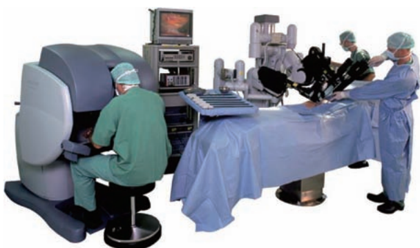
図1 インテュイティブ社の手術支援「ロボット」（または遠隔マニピュレータ）「ダヴィンチ」 DA VINCI surgery "robot" (or telemanipulator) from Intuitive Surgery inc
