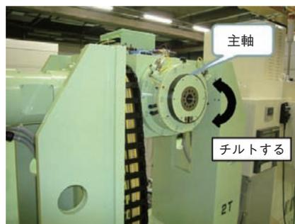
図7 高速チルト試験機の外観
