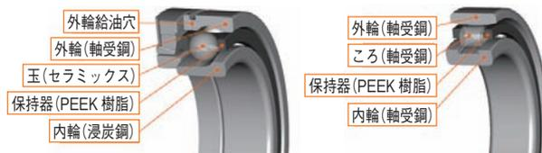
図5 超高速アンギュラ玉軸受(dmn 値:400万)と超高速円筒ころ軸受(dmn 値:300万)
