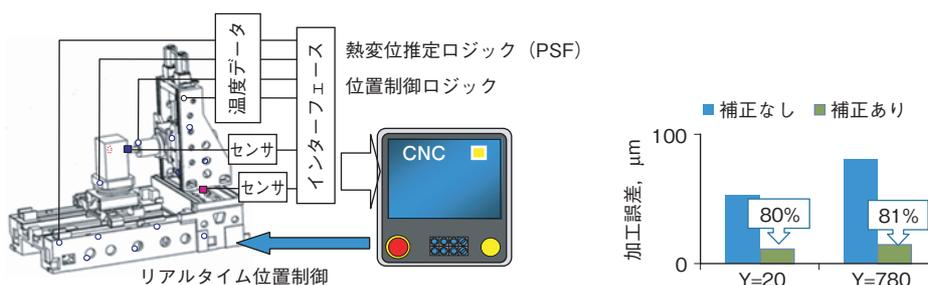
図4 リアルタイム熱変位補正とその効果
