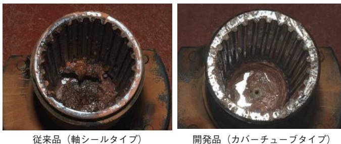
図24 スプラインの泥水耐久試験結果 Muddy water test for spline seal
