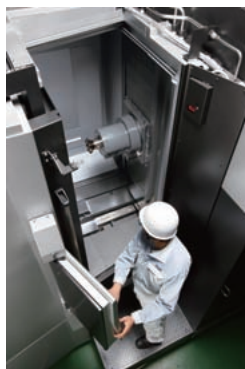
図7 作業員扉 Operator door
