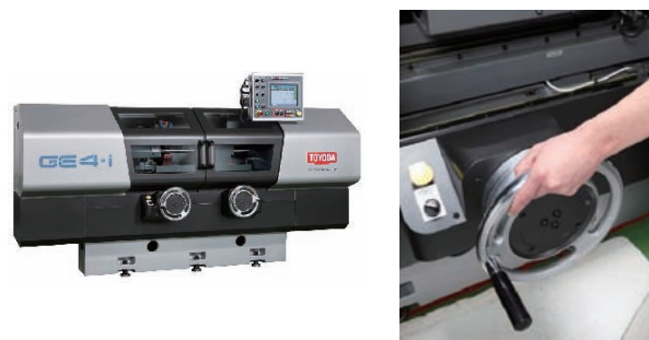
図10 機械前面手動操作ハンドル Manual handle at front of machine
