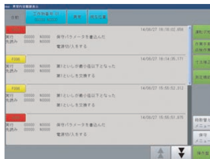
図 7 異常履歴記録機能 Error history record function
