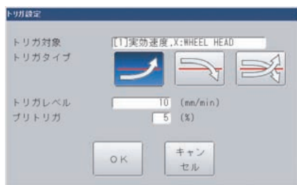
図9 サーボサンプリング開始トリガ機能 Trigger function to start servo sampling
