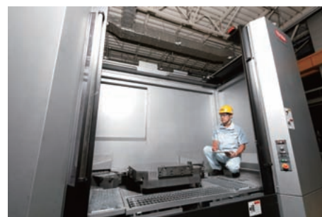
接近性の良いパレットチェンジャ部
