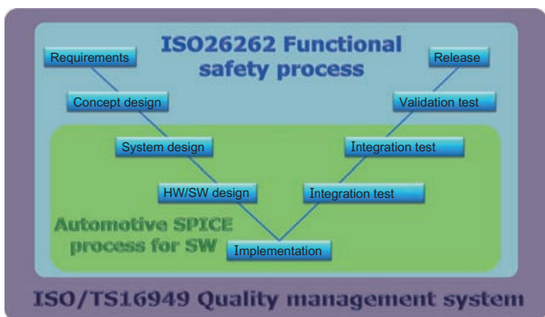
図7 機能安全 V 字プロセス V-model of functional safety
