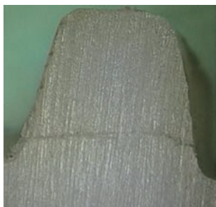
図8 非強化 PA66 を用いたウォームホイールの耐久試験後歯面観察結果
