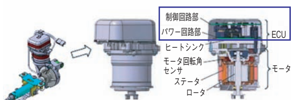
図2 ECU / モータ構造図 Structural drawing of ECU/motor
