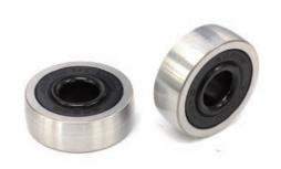
自動車のスライドドア用軸受は、スライドドア本体を支持し、ドアをスムーズに開閉するために使用される. 近年、自動車の室内空間の拡大に伴い、取付位置が車両外面に近接する傾向にある.このため、被水環境が悪化し、外径面のさびの発生が問題となっている.
