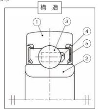
2) 高耐食性を発揮するため、外部露出面に熱処理後研磨加工を実施し、耐食性が低い極表層部を除去.
