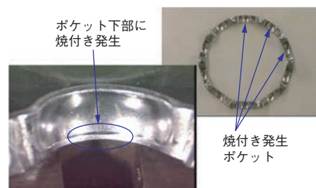
図1 高速回転試験後の鉄保持器の状況 State of iron cage after high-speed test
