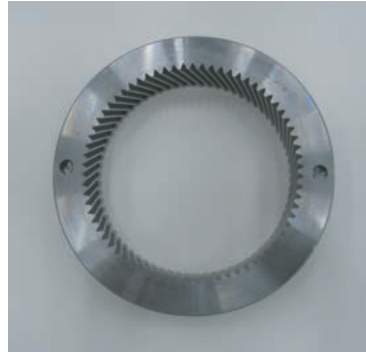
図9 リングギヤ加工事例 Example of machining ring gear
