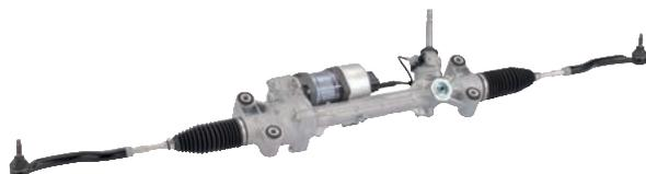
自動車向け機能安全に関する国際規格 (ISO 26262) に準拠し、電動パワーステアリングの ECU ハードウェア故障時のアシスト継続とギヤ内部から MCU (Motor Control Unit) への水浸入に対する耐性や耐腐食性を実現させたラック平行タイプ電動パワーステアリング用 MCU を開発したので紹介する。
