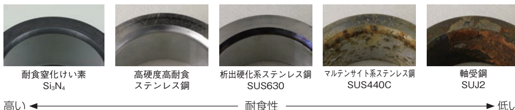
図2 耐食試験事例（CASS試験結果）
