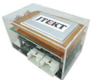
図 1 EPS 補助電源システムの試作品外観 (W137×D83×H80mm)
