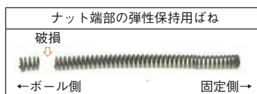
図7 耐久評価によるばね破損部位の確認 Confirmation of spring breakage position by durability test
