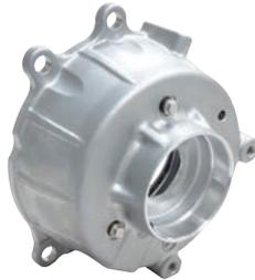
FF 車ベースのクロスオーバー SUV に採用された新 4WD システムのディスコネクト機構用電磁クラッチを開発した。ディスコネクトはオンデマンド 4WD 車において、4WD 走行不要時にプロペラシャフトの回転を停止させることで燃費の低減を図る機構である。今回開発した電磁クラッチは、電流に応じたトルクコントロールを行うことで、ディスコネクト機構をスムーズに動作させることができる。
