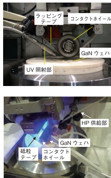
図 1 紫外線援用テープ研削装置 UV-assisted tape grinding equipment
