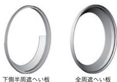
図14 遮へい板の構造 Shield plate structure
