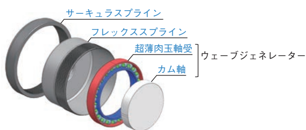
図2 波動歯車減速機の構造 Structure of strain wave gearing
