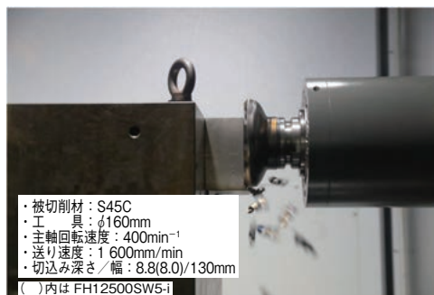
フライス加工事例
