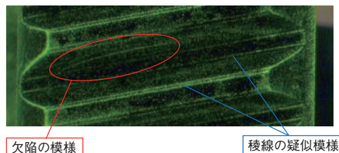
図2 ラック歯部稜線に発生した疑似模様 False indication on rack teeth ridgeline
