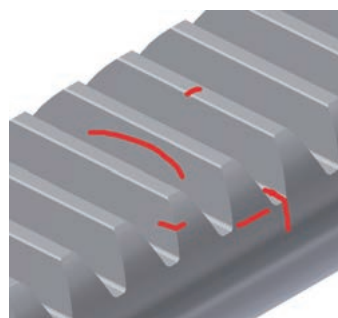
図3 ラック歯部に発生する焼き割れの種類 Types of cracks in rack teeth
