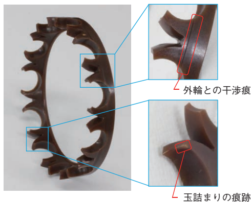
図4 高速回転試験後の冠形樹脂保持器 Resin snap cage after high-speed test
