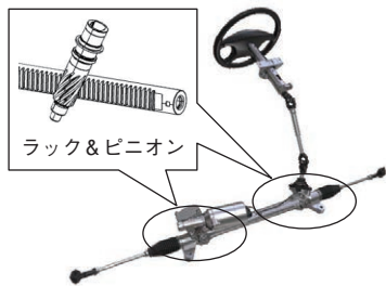
図1 デュアルピニオン式 EPS Dual-pinion type electric power steering
