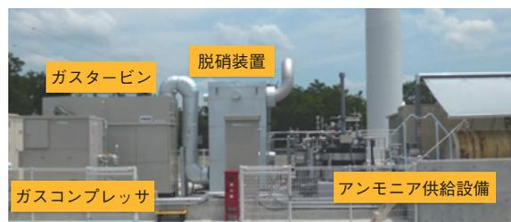
図8 アンモニアガスタービン試験設備
